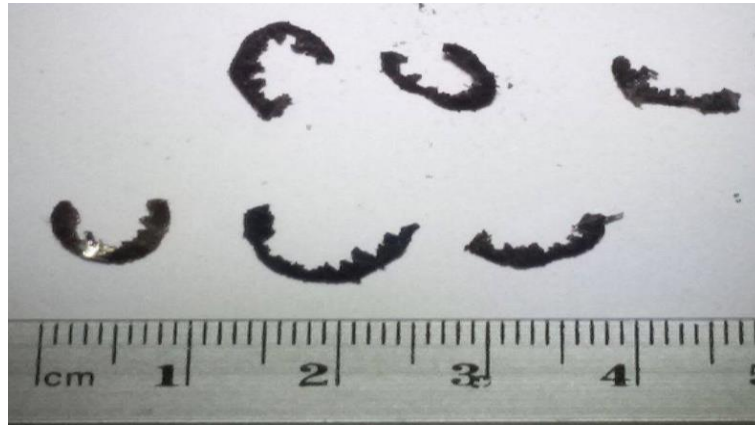
Figura 21: Cavaco gerado pela ferramenta de corte de ângulo negativo e sem quebra-cavaco.
