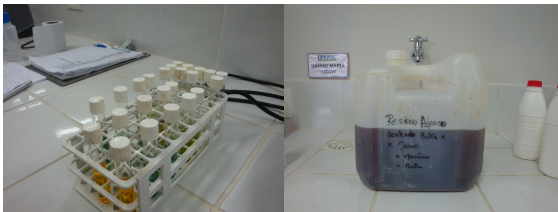
Figura 9 – Frascos contendo resíduos químicos perigosos resultantes da análise de DQO (à esquerda) e de uma bombona contendo resíduo perigoso gerado com a análise de DQO e limpeza de frascos (à direita). Laboratório de Saneamento da UFERSA-Mossoró
