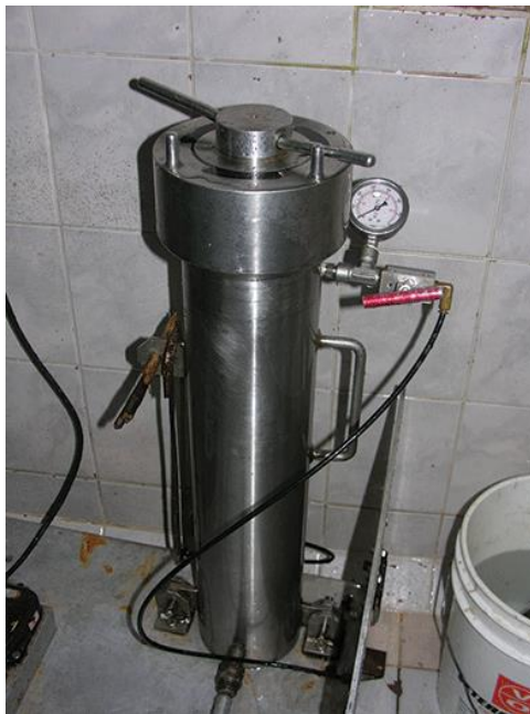
Figura 2. Ilustração de um modelo de câmara hiperbárica para produção de triplóide por choque de pressão (MOREIRA; HILSDORF, 2014)
