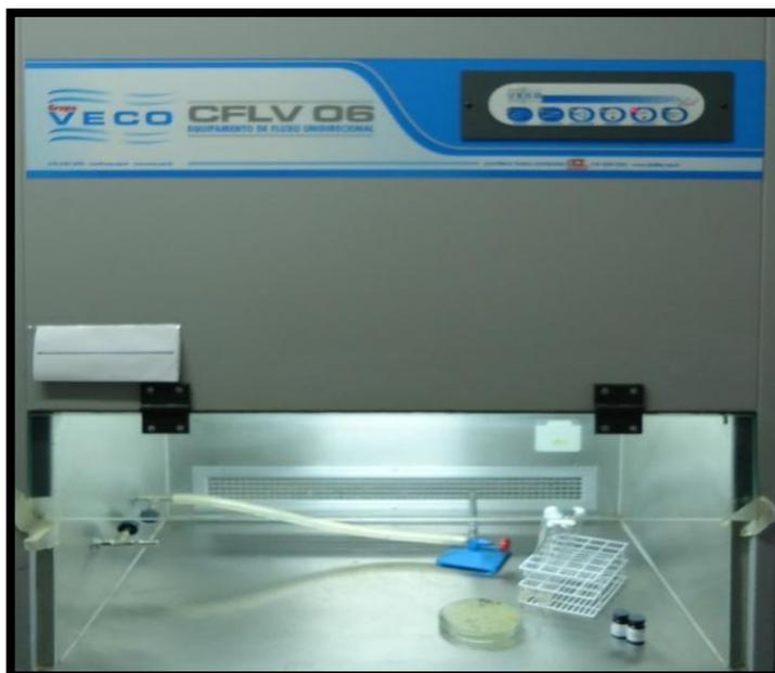
Figura 8 - Câmara de fluxo unidirecional com bico de Bunsen para a realização de análises microbiológicas em condições de assepsia.
